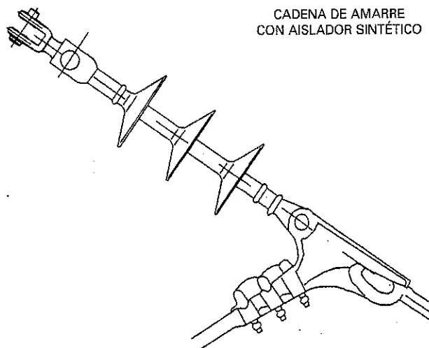
Figura 2.10. Aisladores en cadena sintéticos - Composite (Continuación).
