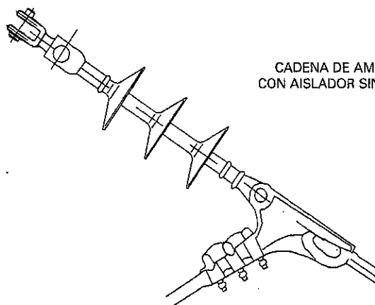
Figura 2.12. Aisladores en cadena - Composite.
