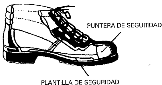
Figura 5.18. Calzado de seguridad contra riesgos mecánicos.
